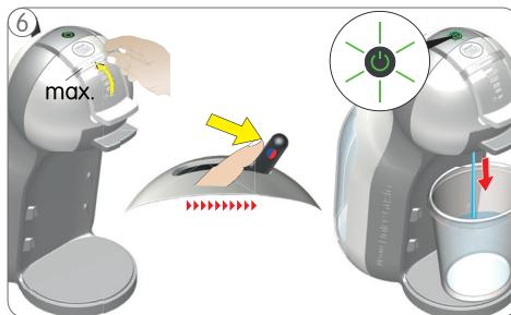
Nastavte ovládač množstva na maximum. Posuňte páčku doprava, začnite preplachovanie kávovaru.
