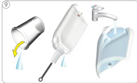
Vyprázdnite a vyčistite nádobu. Prepláchnite a vyčistite zásobník na vodu. Potom ho naplňte čerstvou, pitnou vodou a vložte do zariadenia.
