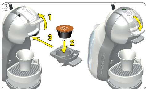
Otvorte blokovaciu rukoväť a vytiahnite držiak na kapsule. Do držiaka na kapsule vložte kapsulu a držiak vložte späť do stroja. Zatvorte blokovaciu rukoväť.
