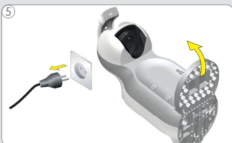
Zariadenie odpojte od napájania. Pre lepší prístup k vstrekovacej tryske nakloňte stroj.
