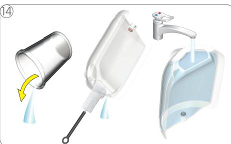
Vyprázdnite a vyčistite nádobu. Prepláchnite a vyčistite zásobník na vodu. Potom ho naplňte čerstvou, pitnou vodou a vložte do zariadenia. Potom vypnite kávovar.
