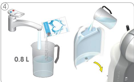
Do 0,8 litra vody v nádobe namiešajte obsah odvápnňovacieho vrecúška. Roztok na odstraňovanie vodného kameňa nalejte do zásobníka na vodu a zásobník na vodu vložte do stroja.
