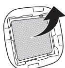
**4** Vložte kryt filtru otočením ve směru hodinových ručiček.
