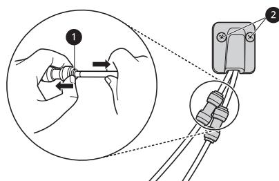
**2** Demontujte šrouby z krytu závěsu v horní části chladničky. Pomocí plochého šroubováku zvedněte hák umístěný na straně krytu u jeho dolní hrany.
