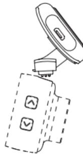
1. GPS modul približite prema držaču kamere kao što je prikazano na gornjoj slici. Pomoću magneta, GPS modul bit će učvršćen u držaču. Ispravan priključak GPS modula pokazuje da je LED dioda GPS (14) upaljena – važi u slučaju ako je priključeno napajanje.
