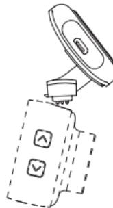
1. Nähern Sie das GPS-Modul der Halterung der Kamera an, so wie es auf dem Bild oben gezeigt wird. Das GPS-Modul verbindet sich mittels der Magneten mit der Halterung. Die richtige Verbindung des GPS-Moduls wird durch die LED-Anzeige für GPS (14) angezeigt - das gilt, wenn die Halterung an die Stromspeisung angeschlossen ist.
