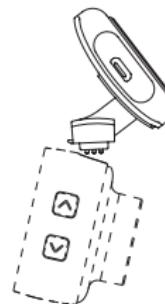
1. Apropiati modulul GPS de suportul camerei in acord cu imaginea de mai sus. Cu ajutorul magnetilor modulul GPS se prinde de suport. Fixarea corecta a modulului GPS este indicata de o dioda LED (14) – valabil doar in cazul fixarii suportului de cablul de alimentare.
