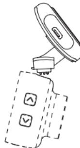
1. Közelítse a GPS modult a fenti képen látható módon a kameratartóhoz. A GPS modul mágnesek segítségével fogatható fel a tartóra. A GPS modul helyes rögzítését világító GPS LED dióda (14) jelzi - abban az esetben érvényes, ha a tartó töltőre van csatlakoztatva.
