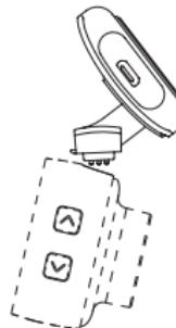
1. GPS modul približajte nosilcu kamere, kot je prikazano na sliki zgoraj. Modul GPS se k nosilcu pritrdi s pomočjo magnetov. Pravilno pritrditvev GPS modula signalizira prižgana LED dioda (14) – velja v primeru priključitve nosilca na napajanje.
