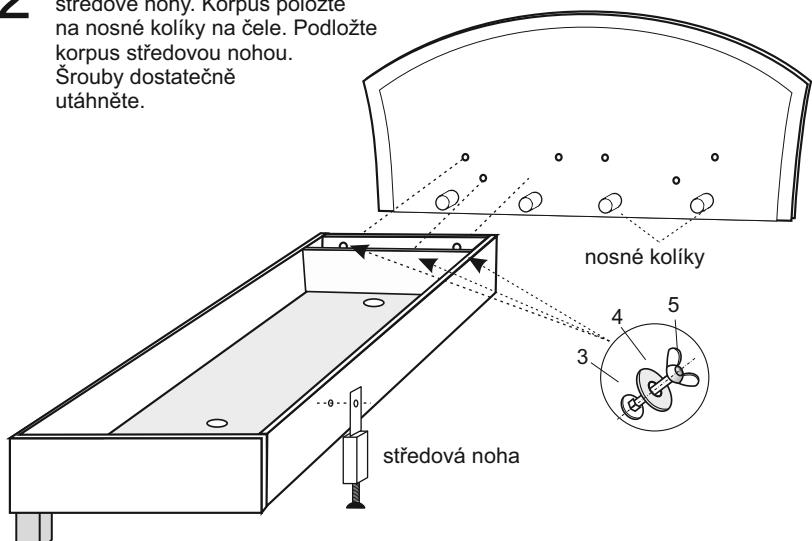
3 Montáž druhého korpusu. Spojení korpusů se středovou nožkou šroubem č. 2. Větrací mřížky č. 6. Dotažení všech šroubů !!!
